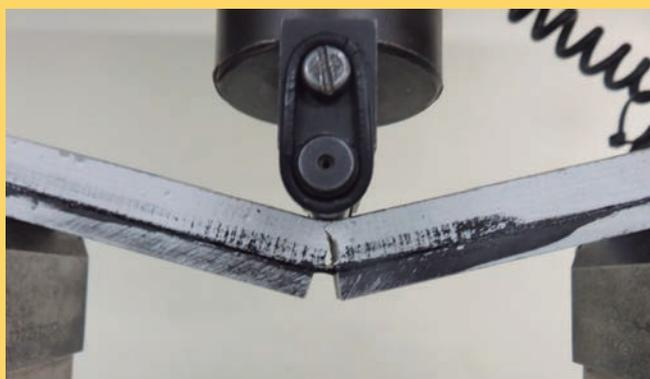
*Deformación de un panel híbrido obtenido con adhesivo flexible (ITC)*
