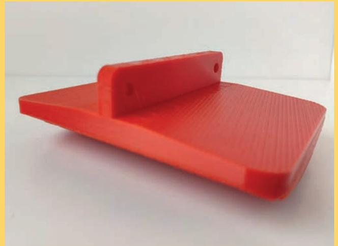
*Componente del respirador realizado por impresión 3D en los laboratorios de la AICE*
