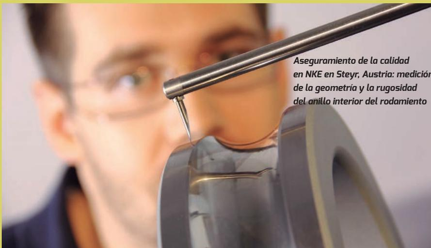
Aseguramiento de la calidad en NKE en Steyr, Austria: medición de la geometría y la rugosidad del anillo interior del rodamiento
