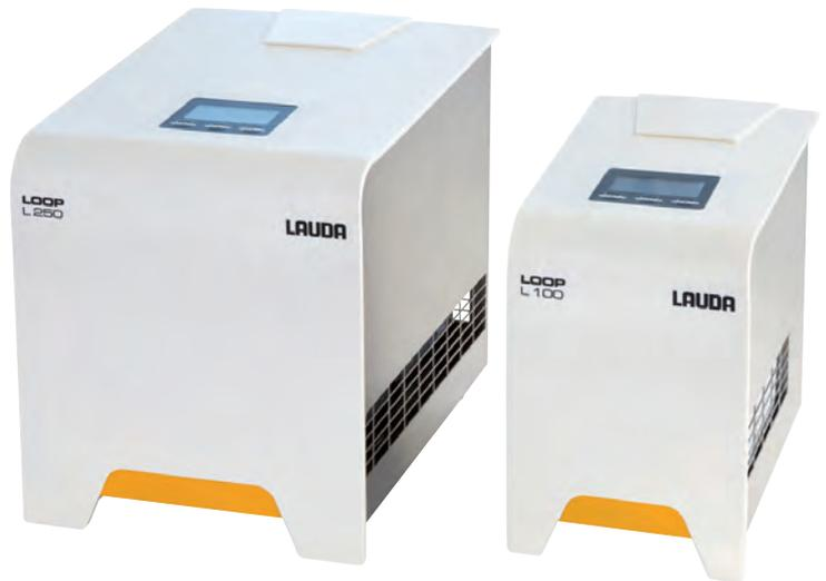
**El termostato de circulación Lauda Loop funciona con la modernísima tecnología de Peltier en el intervalo comprendido entre 4 y 80 °C. Ambos modelos (L 100 y L 250) cuentan con refrigeración por aire y ofrecen una potencia de frío de 120 y 250 W, respectivamente.**
