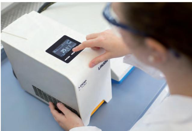
**Gracias a su pequeño tamaño y bajo peso, el Lauda Loop se puede usar en el laboratorio para las aplicaciones más diversas. Su manejo, guiado por menús, se efectúa mediante tres teclas. Los datos se muestran en una pantalla OLED de alto contraste e iluminación intensa.**
