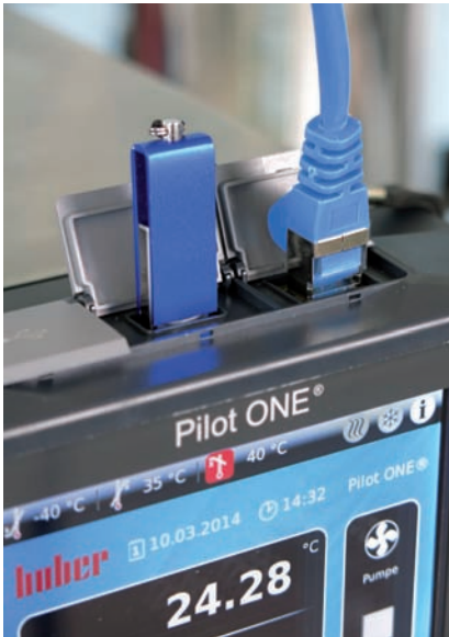
Figura 5. Los modelos con Pilot ONE están equipados con conexiones USB y LAN para el acceso remoto y el almacenamiento de datos.
