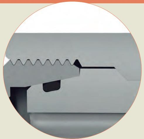
*El seguro de bloqueo reduce el riesgo de fugas en el área de obturación de la válvula*
