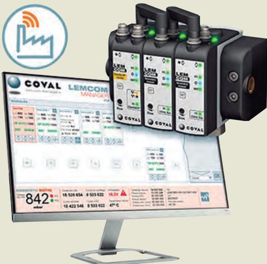
Entre las funciones que ofrece, está la importación/exportación de parámetros, el análisis de ciclos de vacío, el seguimiento del funcionamiento y las alarmas, la ayuda de la configuración e incluso la actualización del software.
